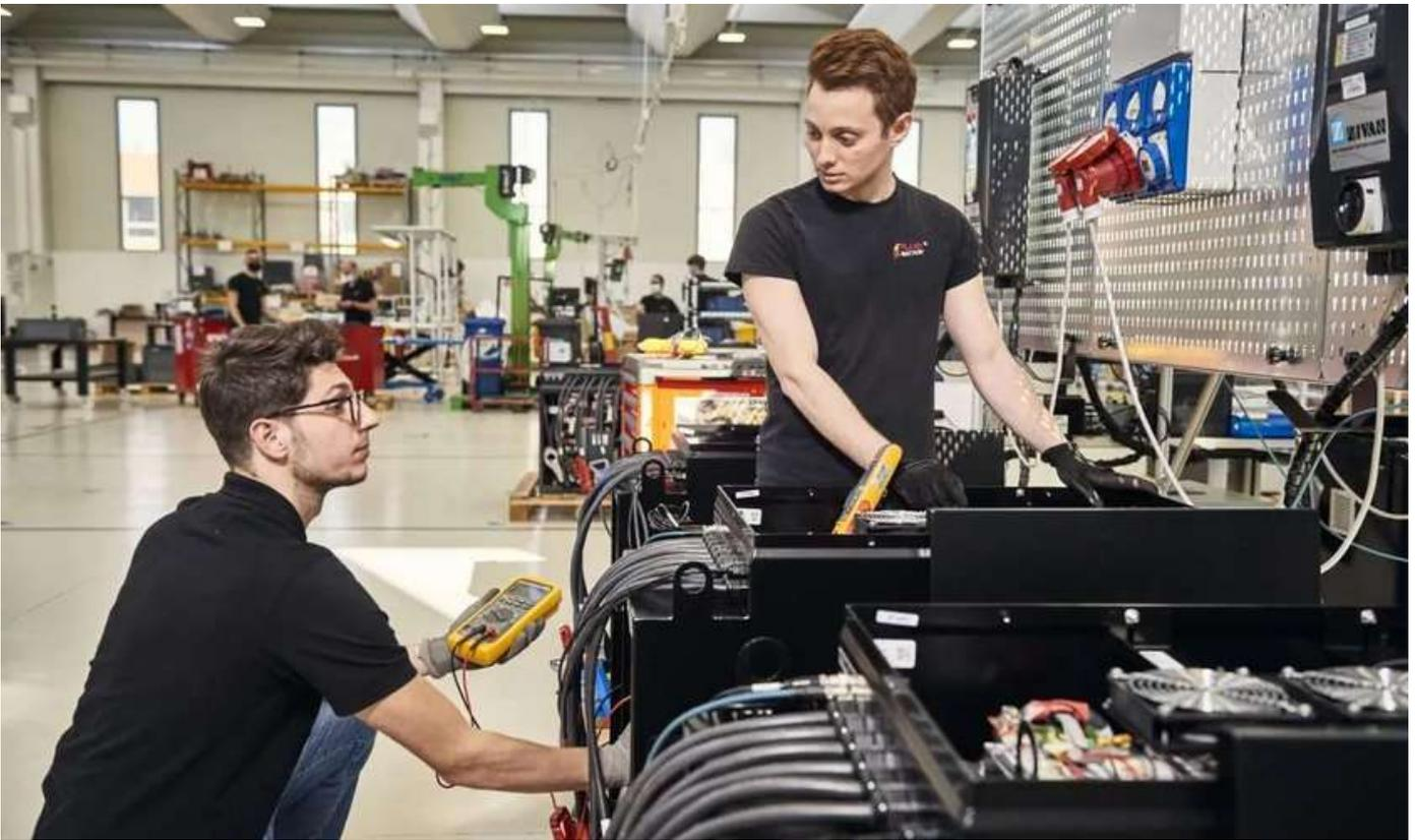
Durante il collaudo si verifica, infatti, che tutti i parametri funzionino perfettamente e che la batteria dialoghi nella maniera corretta con la macchina e con il caricabatterie, strumento essenziale che Flash Battery fornisce insieme alla batteria, grazie a diverse collaborazioni in essere con i principali player di riferimento del settore.
