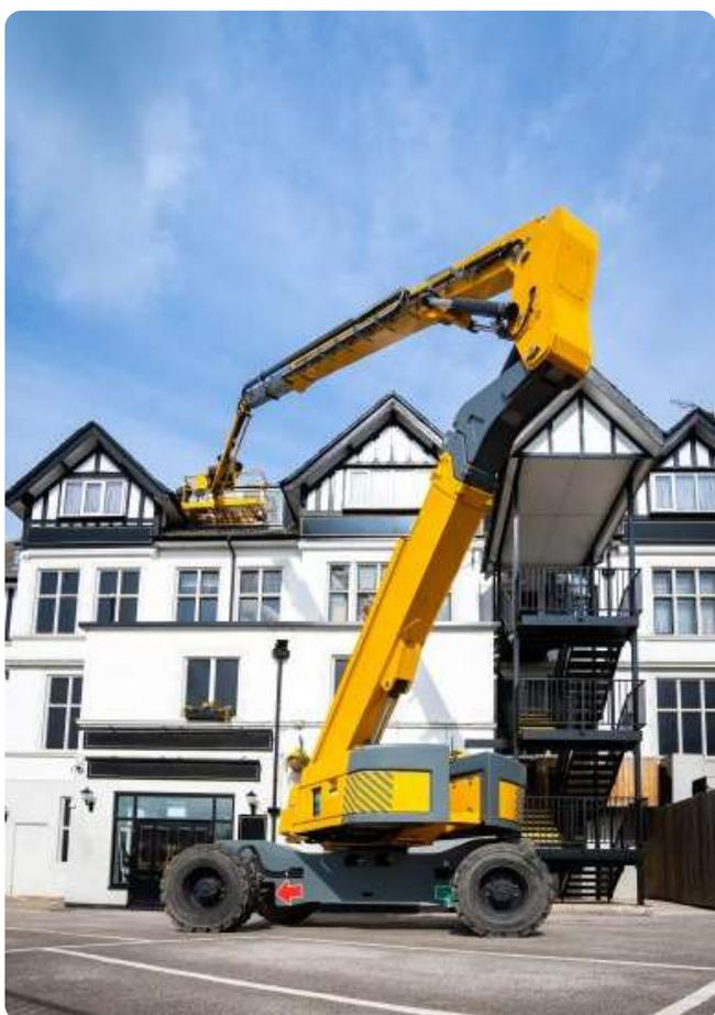
**Le PLE sono state le macchine per sollevamento elettrificate *ante litteram*, quindi più “avanti” nel processo di elettrificazione: da cui un precoce delinearsi delle esigenze degli OEM, che oggi chiedono in gran parte taglie di batteria dai 10 ai 40kWh, ideali per movimentare queste macchine che sfruttano anche gli altri vantaggi legati alle batterie al litio, ossia:**
