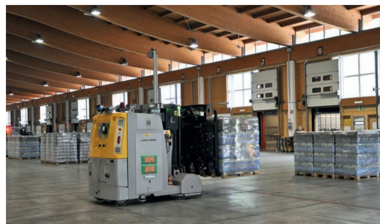
Oltre a garantire una precisione superiore al 99,5%, gli LGV sono veicoli intelligenti, più efficienti e "green" anche grazie al fatto di essere dotati di batterie ricaricabili agli ioni di litio che sfruttano l'innovativa tecnologia di Flash Battery
