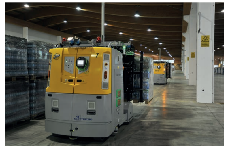
Tra le soluzioni alla base della smart factory Acqua Sant'Anna c'è l'utilizzo di 52 veicoli a guida laser (LGV) forniti da Elettric80 che integrano i fine linea alle spedizioni e interconnettono tutte le operazioni
