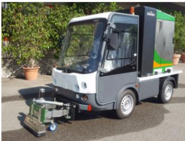
Pick up Gastone allestito come spazzatrice, diserbante
