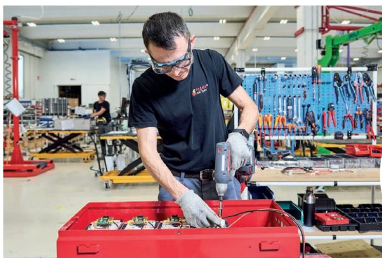
Assemblaggio dei pacchi batteria al litio Flash Battery, progettati su misura per cicli di lavoro industriali e off-highway
