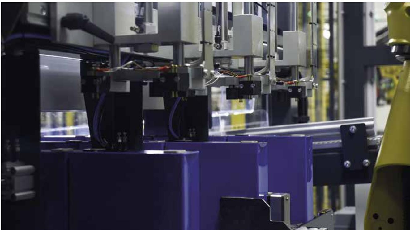
➤ L'ULTIMA FASE DELLA NUOVA LINEA AUTOMATIZZATA DI ASSEMBLAGGIO MODULI AL LITIO CON SALDATURA LASER PREVEDE UN TEST COMPLETO DI VERIFICA PER ACCERTARE L'IDONEITÀ E LA CORRETTA FUNZIONALITÀ DI OGNI SINGOLO MODULO
