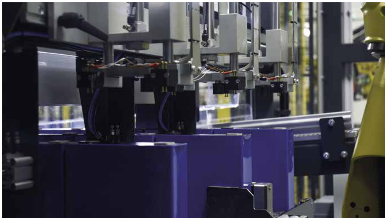
➤ L'ULTIMA FASE DELLA NUOVA LINEA AUTOMATIZZATA DI ASSEMBLAGGIO MODULI AL LITIO CON SALDATURA LASER PREVEDE UN TEST COMPLETO DI VERIFICA PER ACCERTARE L'IDONEITÀ E LA CORRETTA FUNZIONALITÀ DI OGNI SINGOLO MODULO
