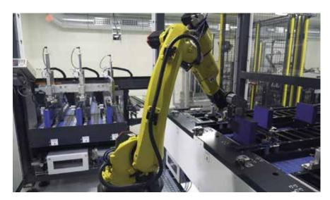
IL PROCESSO PREVEDE QUATTRO FASI: NELLA PRIMA LE CELLE VENGONO CARICATE SULLA LINEA, PER POI ESSERE SOTTOPOSTE A UN CONTROLLO AUTOMATIZZATO CHE PREVEDE L'UTILIZZO DI SISTEMI DI ISPEZIONE OTTICA E SENSORI CHE NE VERIFICANO GLI STANDARD DI QUALITÀ
